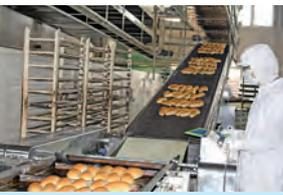
**放冷** 焼き具合を確認し、ベルトコンベア上を流れながらパンが冷まされる。
